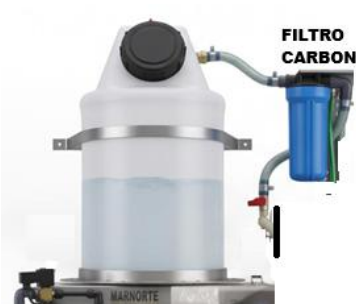
TANQUE DE FLUSH Y LIMPIEZA QUÍMICA
